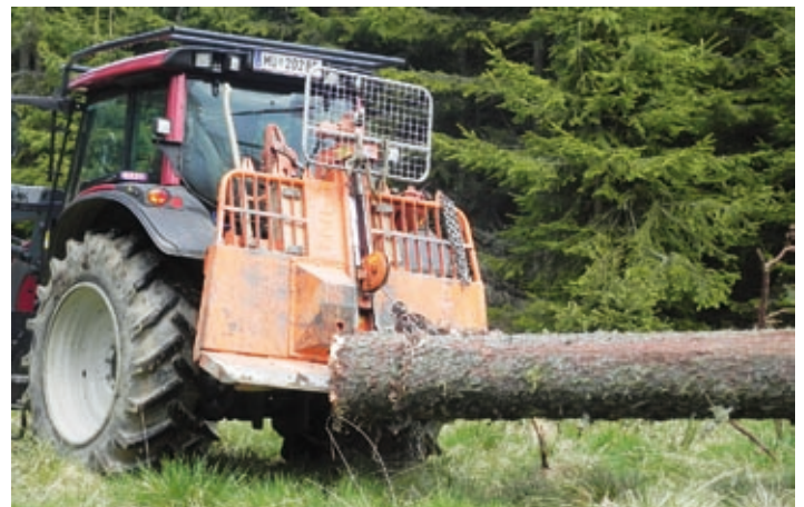
Die Rundholzbringung mit Seilwinde im ebenen bis angehenden Steilgelände zählt zu den häufigsten Einsatzbereichen des Forsttraktors.
