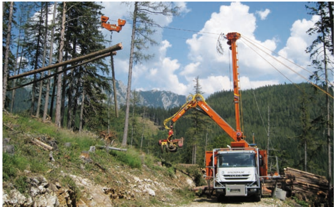
3,4 Mio. Festmeter Rundholz, das sind 22 Prozent des gesamten in Österreich erzeugten Holzes, wurden im vergangenen Jahr mittels verschiedener Trageseilsysteme zu den Forststraßen transportiert.
