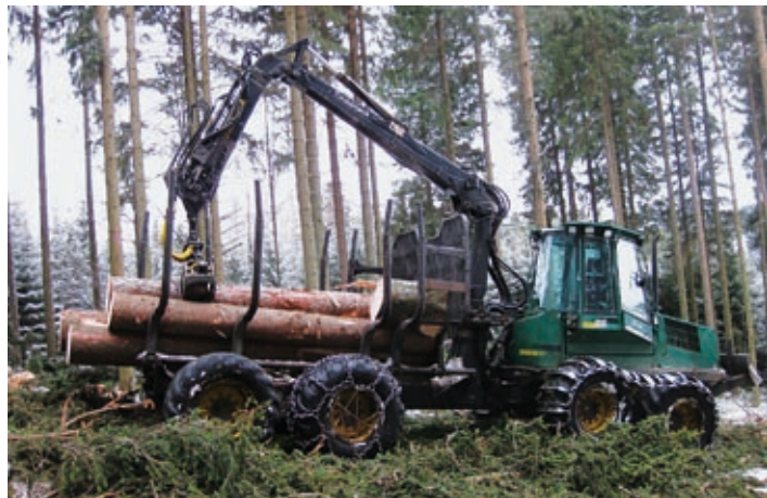
Aufarbeitung und Rückung von Schneebruchholz mit dem Harvester (Bild links) und dem Forwarder Timberjack (Bild rechts).
