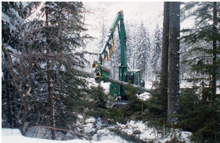
Aufarbeitung und Rückung von Schneebruchholz mit dem Harvester (Bild links) und dem Forwarder Timberjack (Bild rechts).
