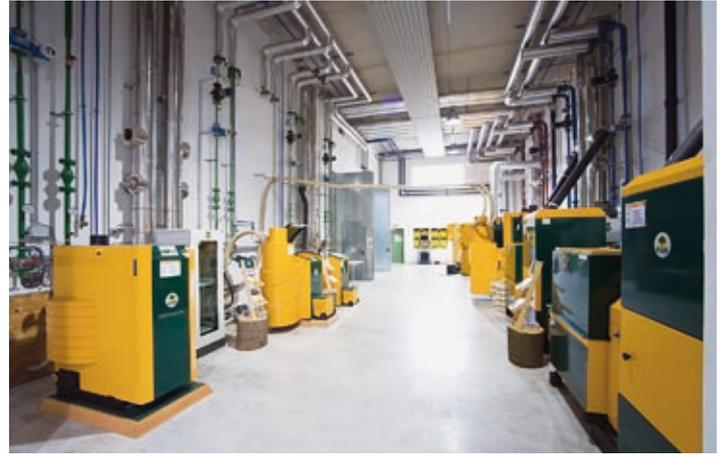
*KWB-Heizungen auf dem unternehmenseigenen Prüfstand. Hier wird auf Wirkungsgrad, Verbrennung und Emissionen hin geforscht und analysiert.*
